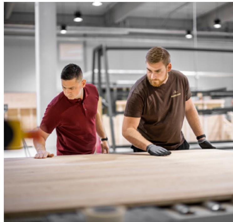
Nach dem Ausbessern ist die Platte ein schwerer hölzerner Rohdiamant, der zur Schleifstation hinübergehievt wird.
