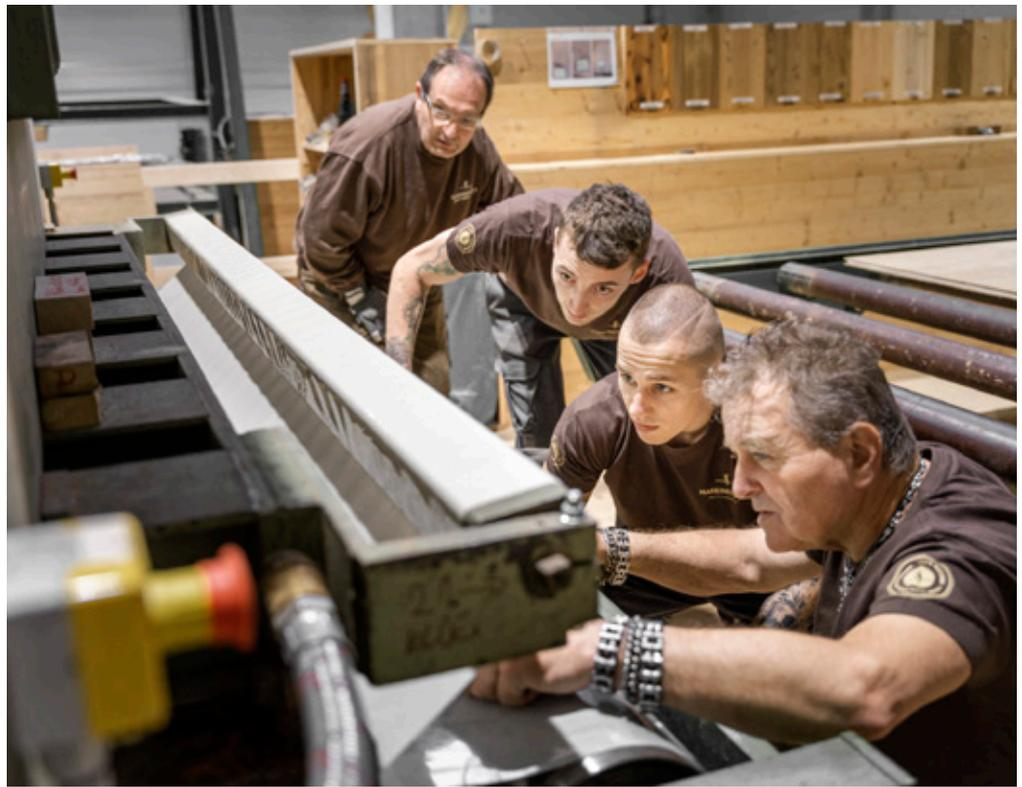
Jan mit dem oberflächenbehandelten linken Arm legt zwecks Verleimen gerade die Mittel- auf die Rückenlage auf. Dazu braucht's eine ruhige und genaue Hand.
