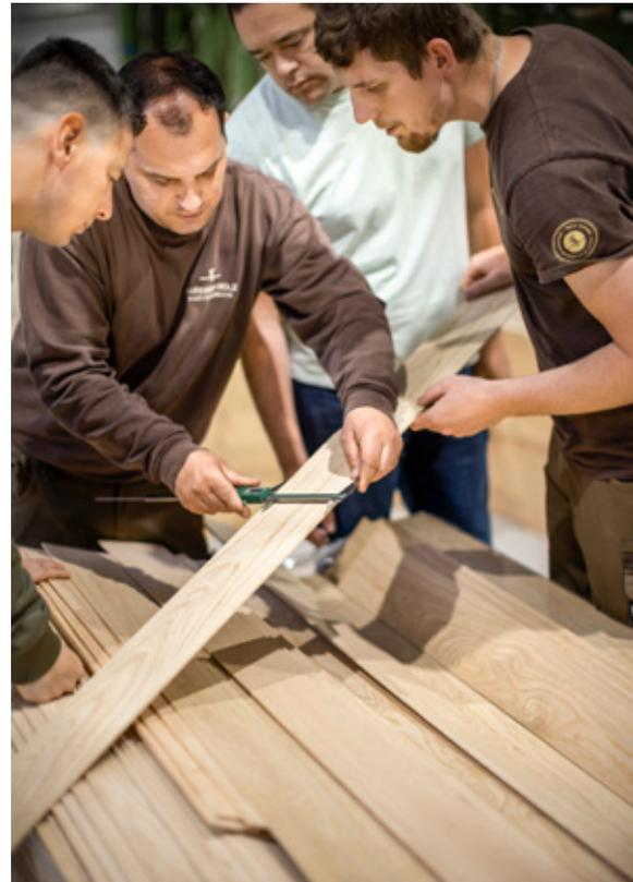
Weil es um mehr bzw. weniger als Millimeter geht, muss zur Ermittlung der Lamellenbreite eine Schieblehre vulgo Messschieber her.
